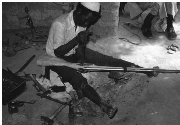
図57 自動車の廃品ステアリング・ロッドを利用して、燧石銃の銃身を作る村の鍛冶屋。裸足の平座位が、足指での対象の固定を可能にしている。西アフリカ・マリ中部のセグーで、1991年、筆者撮影
